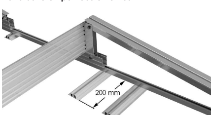
Los portalastres internos siempre se dirigen hacia el interior, dejando el lastre oculto bajo el módulo.
