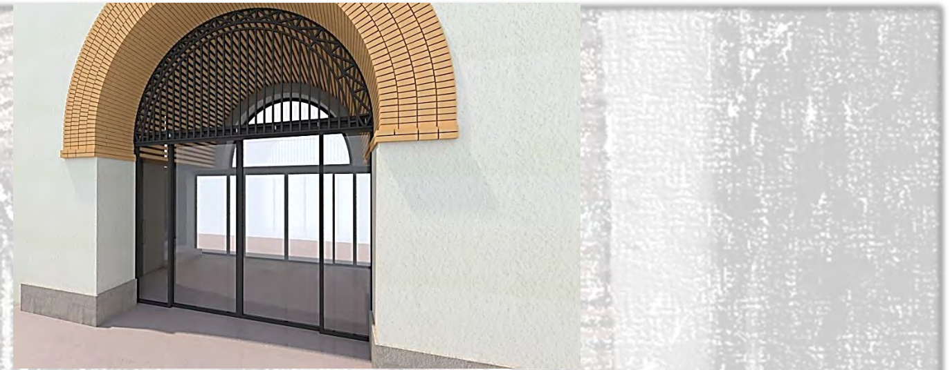
En l'accés principal per l'Avinguda alcalde Palau, es proposa extrusionar l'arc exterior amb un fals sostre de lames ceràmiques vistes, minimitzant la visió de les portes dels bany que queden integrades en el panelat de les parets.
